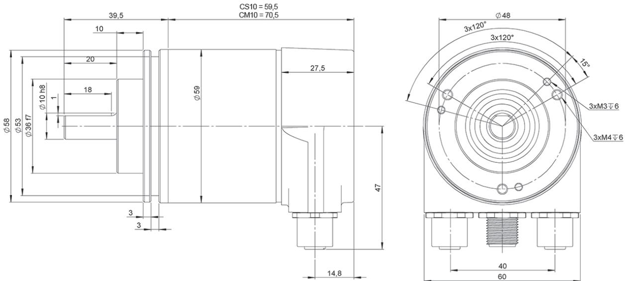
Dessin axe type 2, connectique type 2, clamping
